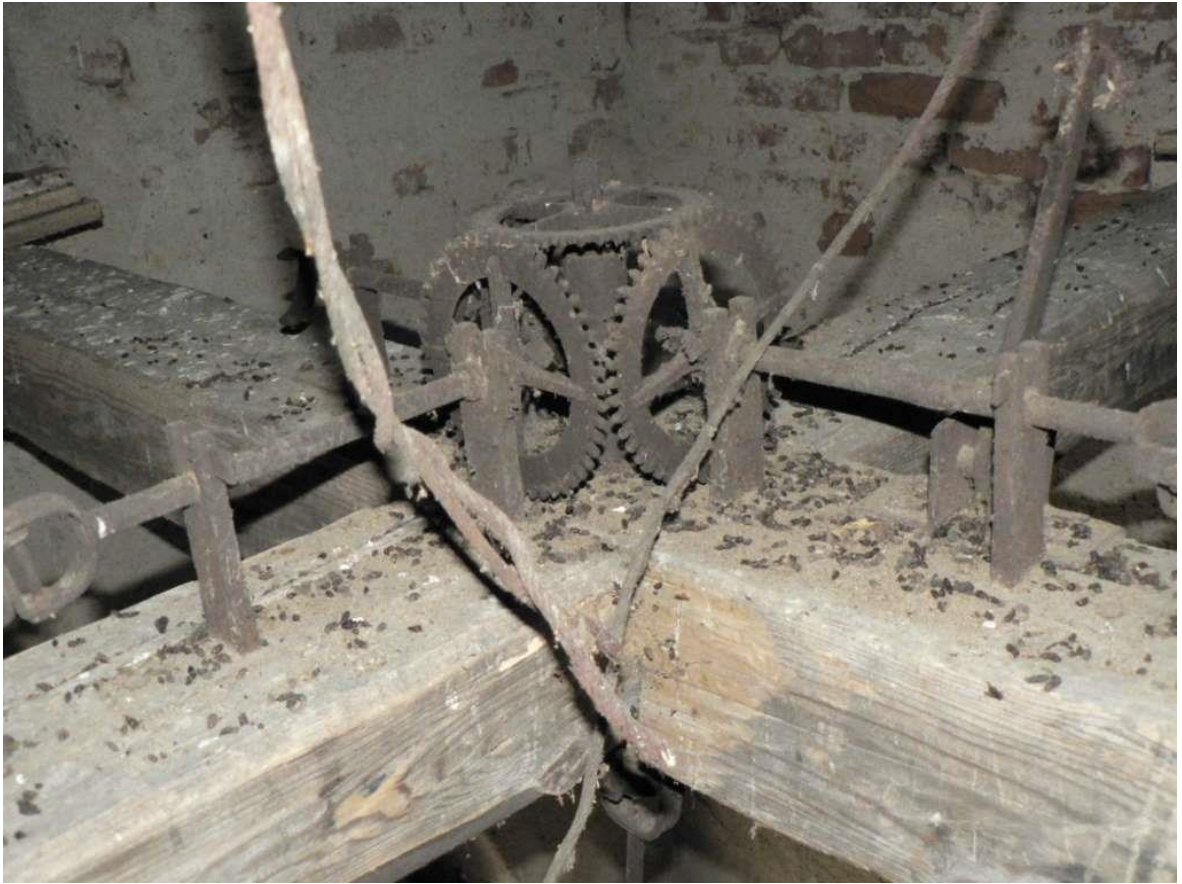
Původní strojek rozvodu točivého momentu pro tři ciferníky
