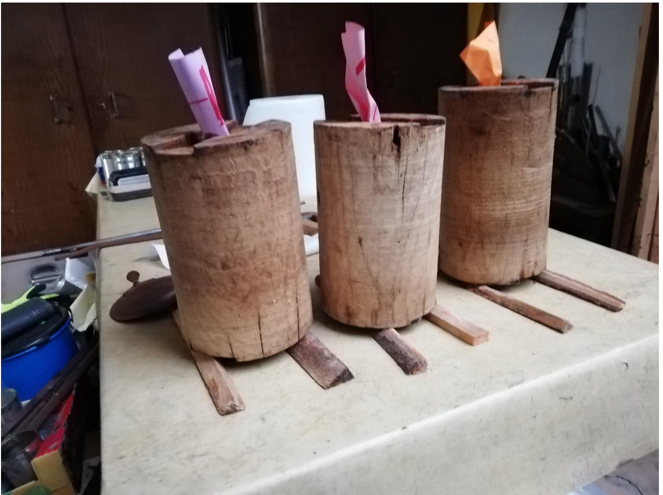
Dřevěné lanové bubny po očištění
