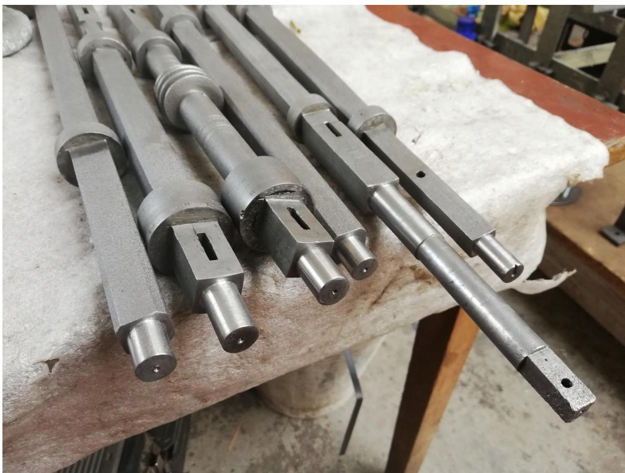
Postup úpravy čepů v soustruhu
