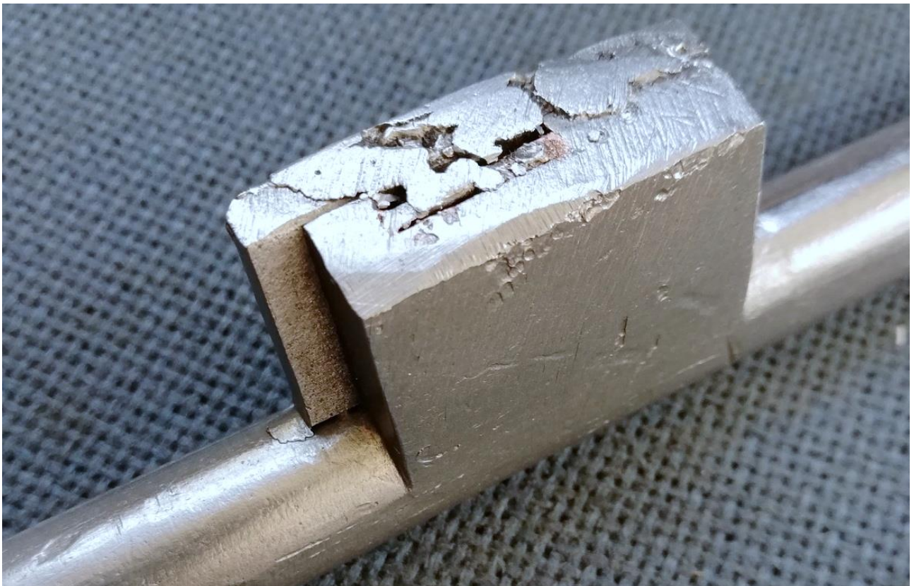
Stav palet krokového mechanismu před úpravou
