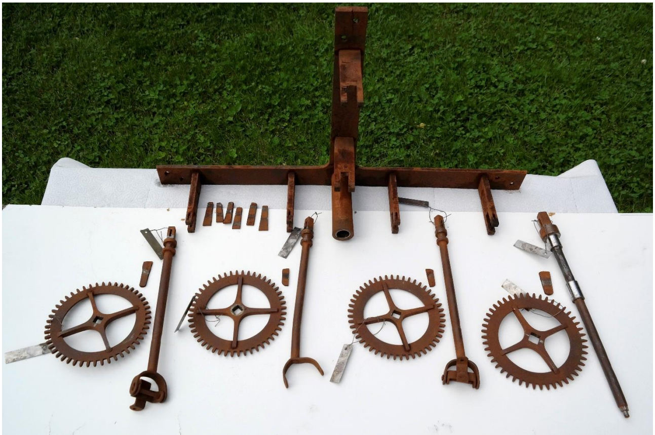
Díly strojku rozvodu po očištění v louhu, dole stav po odstranění koroze
