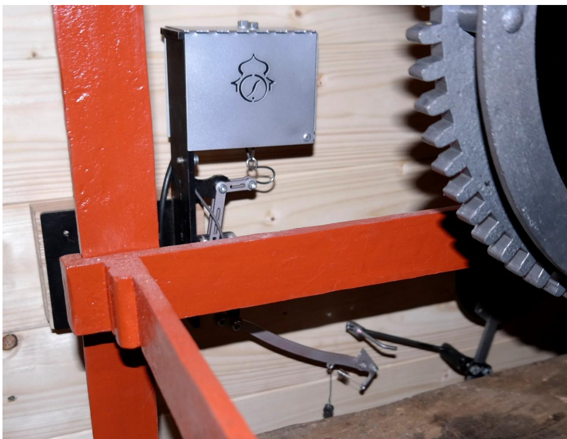
Elektromagnetický záchyť kyvadla systému synchronizace s přesným časem
