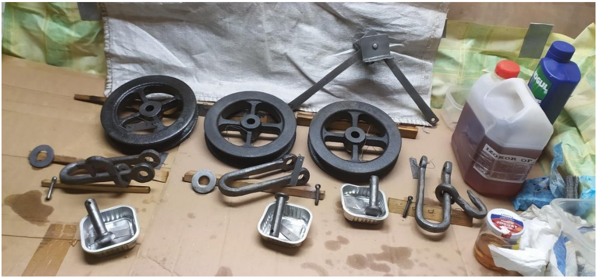
Koroze ucha závažové nádoby. Dole volné kladky závaží po očištění.
