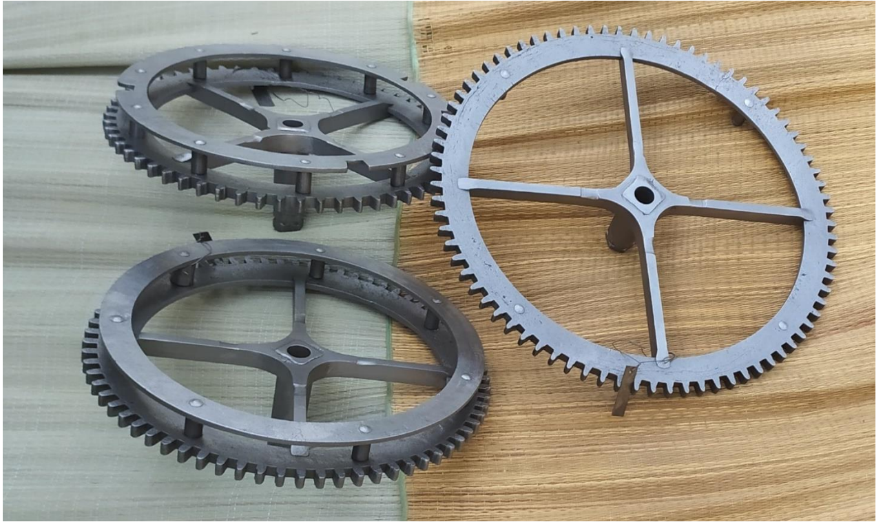
Hlavní kola bicích strojů a stroje jícího po očištění
