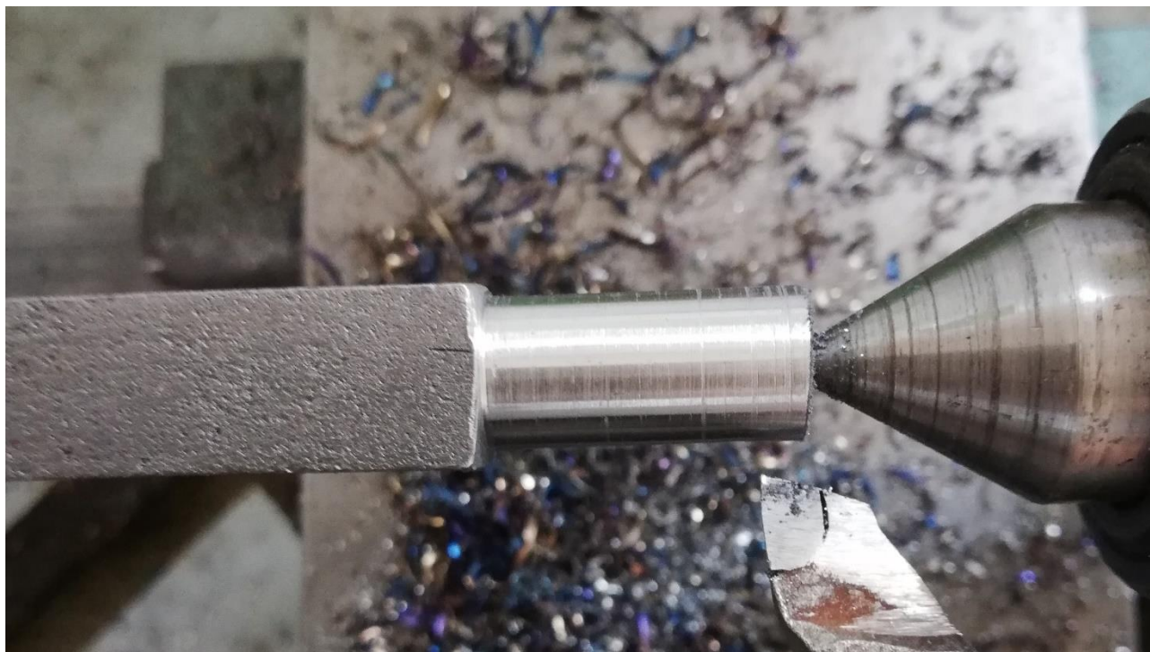
Postup úpravy čepů v soustruhu
