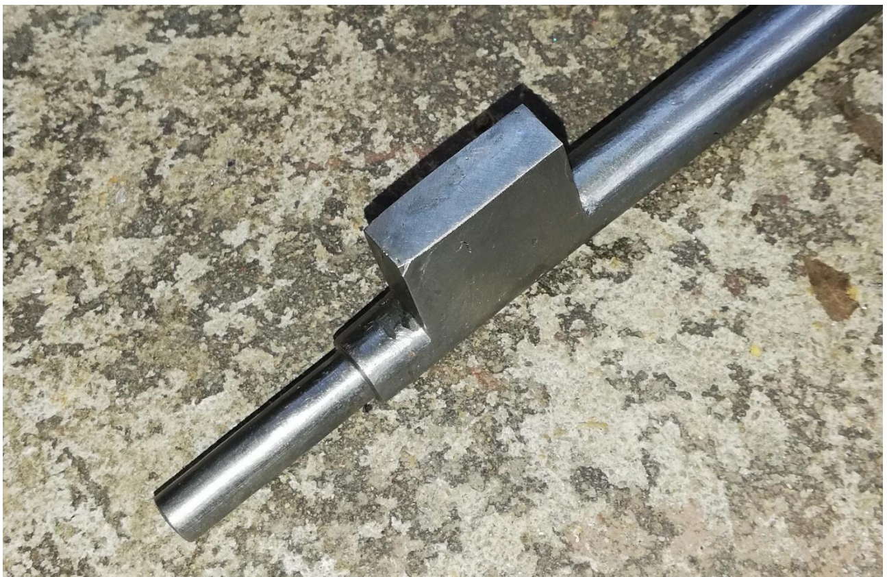
Paleta vřetene po navaření nového materiálu, opracování a zakalení
