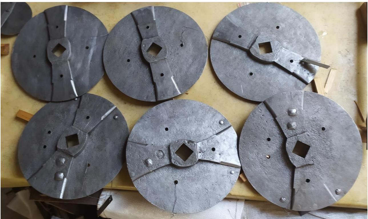
Čela lanových bubnů před a po odstranění koroze
