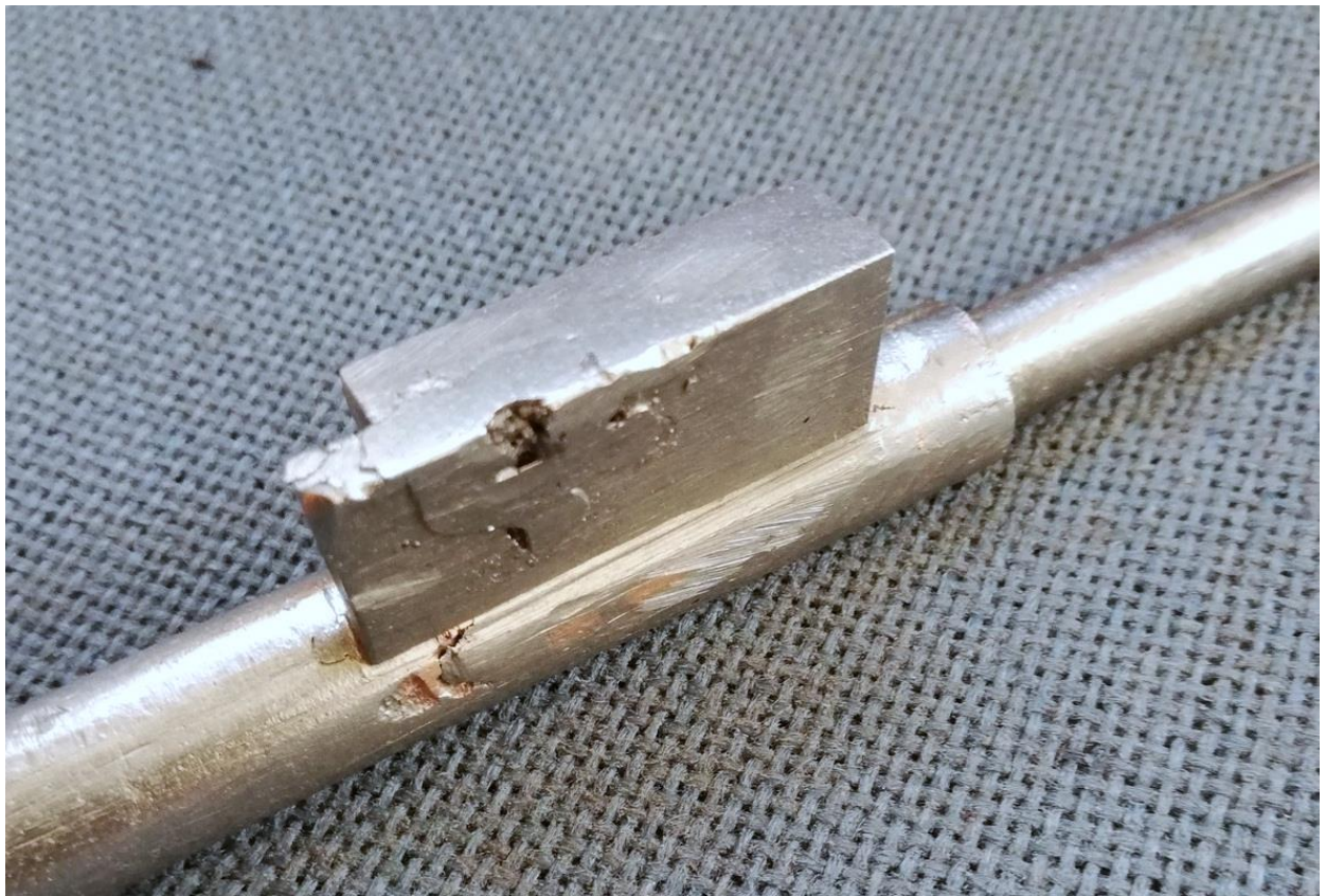
Stav palet krokového mechanismu před úpravou
