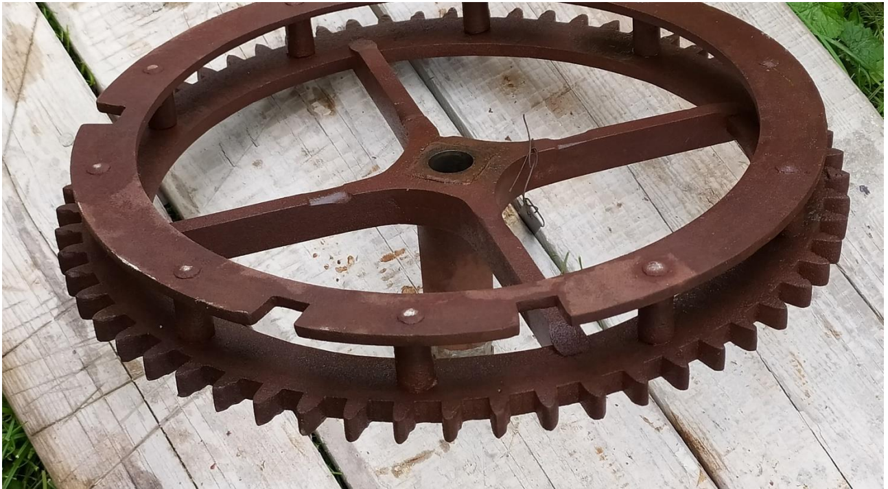
Hlavní kolo bicího stroje čtvrt'ového po odstranění nečistot v louhu
