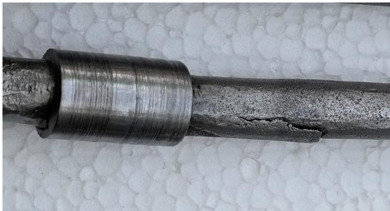
Nalomená svislá hřídel strojku rozvodu točivého momentu
