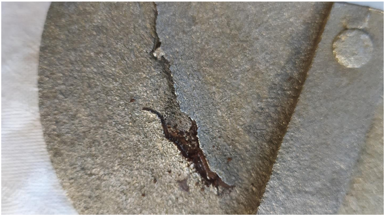
Koroze plochy větrníku a natahovacích hřidelí
