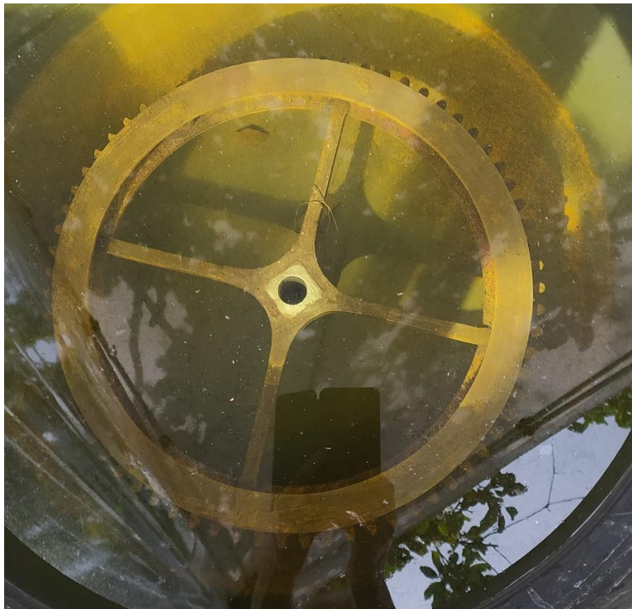
Hlavní kolo bicího stroje čtvrt'ového a ložiskové plotny v odrezovací lázni
