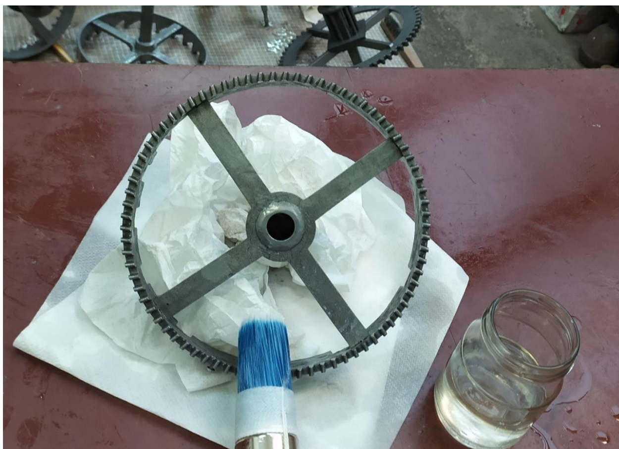
Aplikace silikonového oleje na díly opatřené ochranným nátěrem akryluretanem
