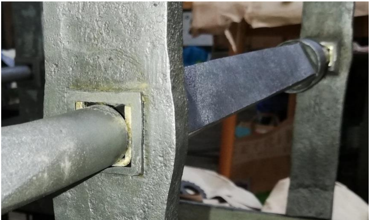
Nové mosazné vložky v ložiskách hlavních hřídelí
