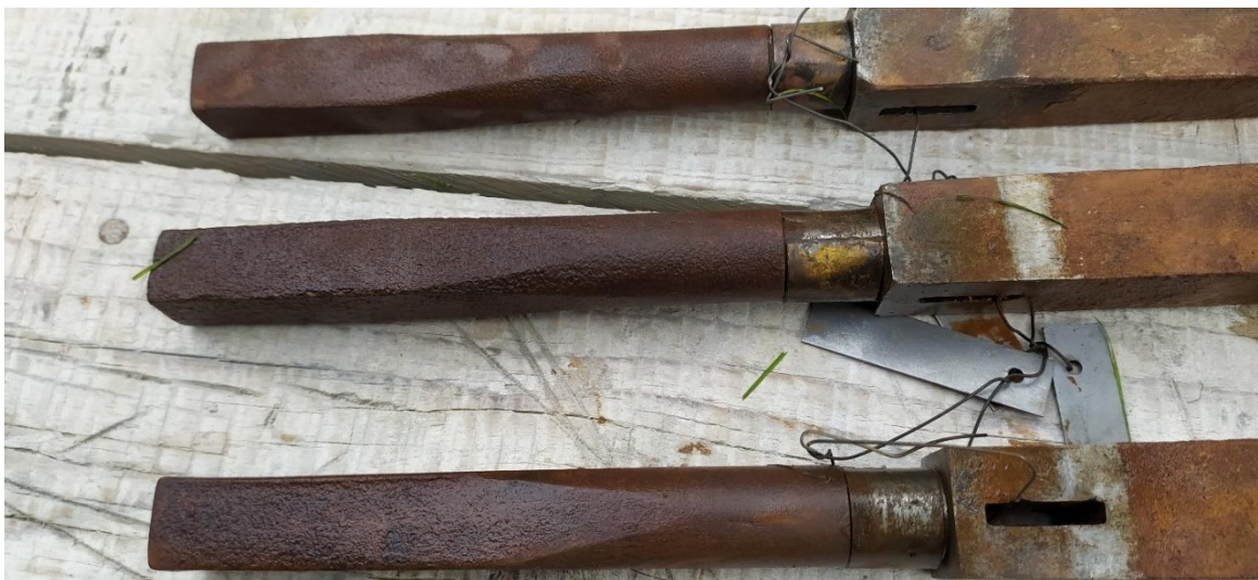
Koroze plochy větrníku a natahovacích hřidelí
