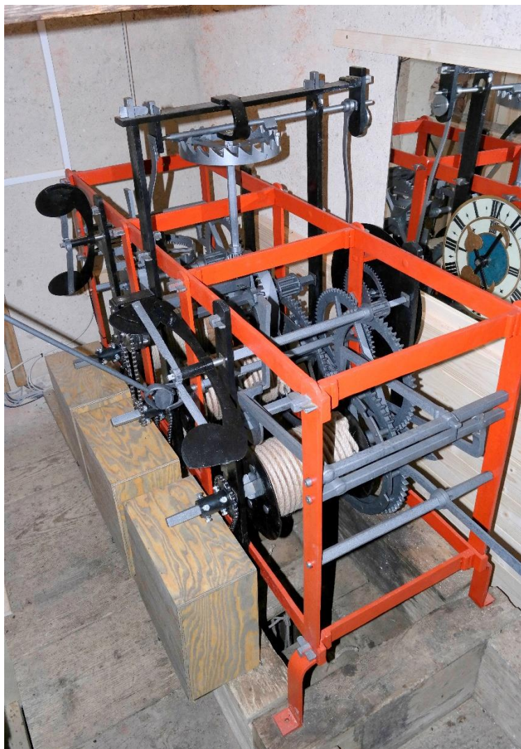
Natahovací stroje s dřevěnými kryty
