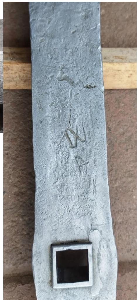
Značky na ložiskových plotnách a na konzoli axiálního ložiska krokového kola
