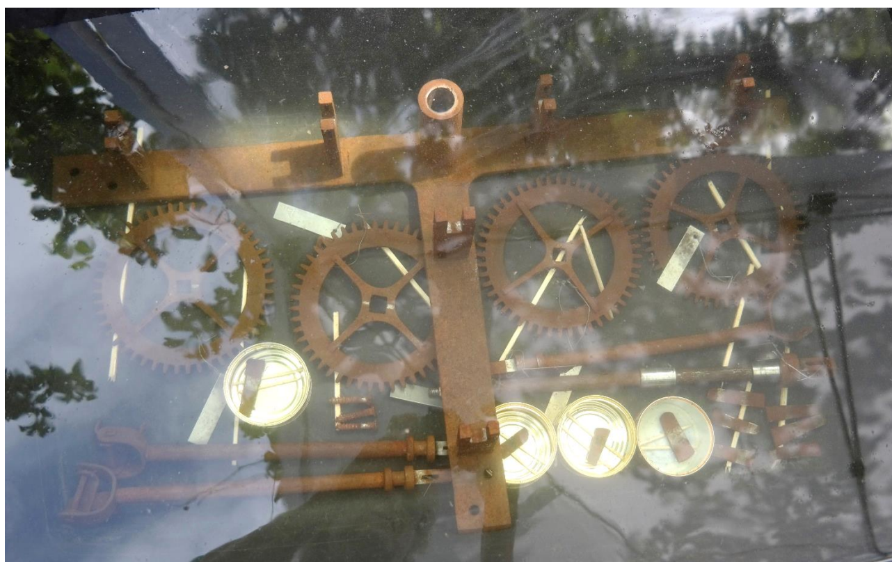
Strojek rozvodu točivého momentu k ciferníkům v odrezovací lázni
