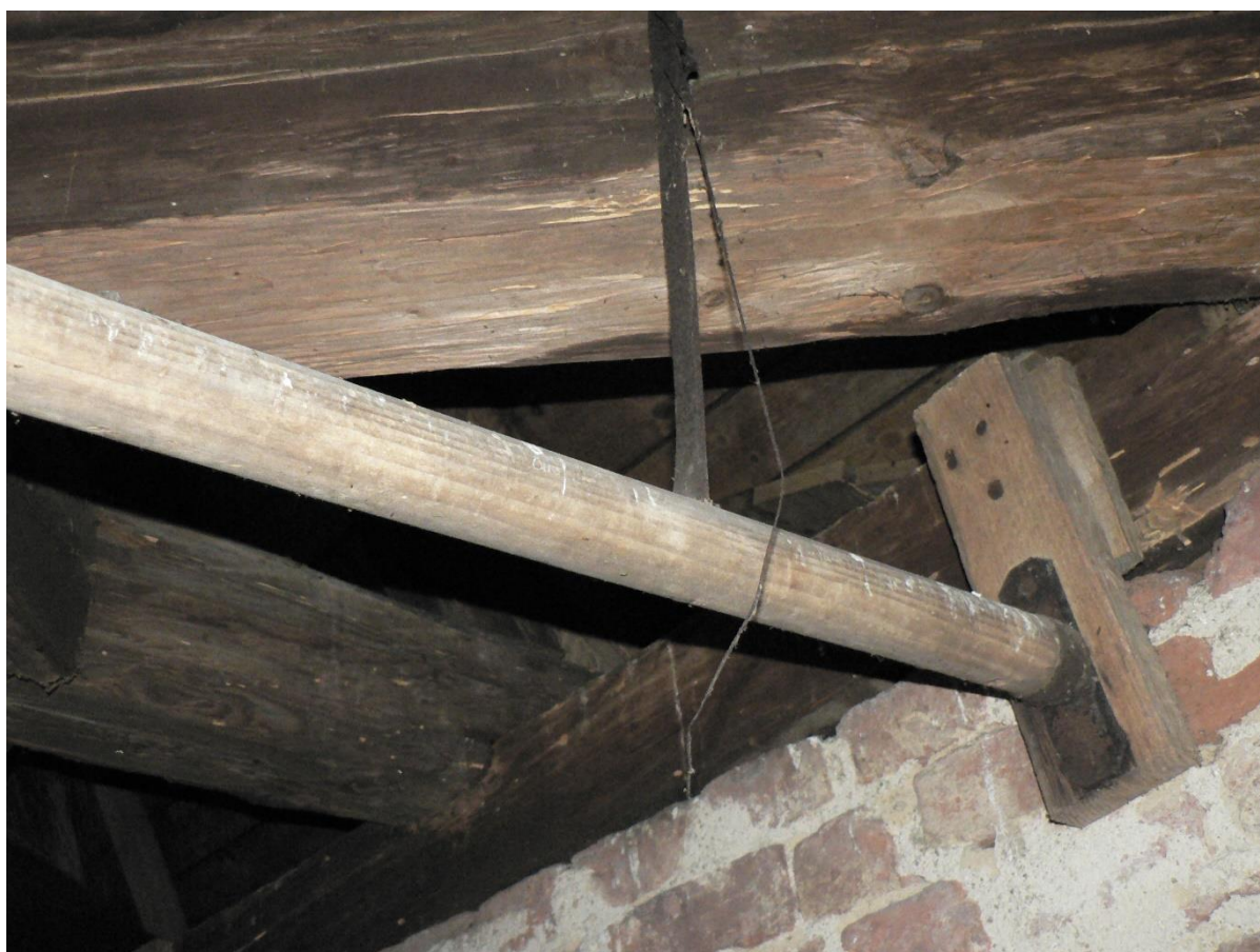
Původní systém převodu tahové síly od bicích strojů k paličkovým strojům
