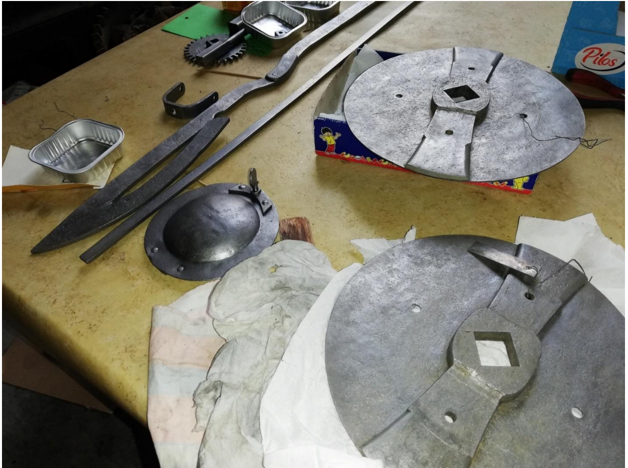
Stav dílů hodinového stroje po odstranění koroze
