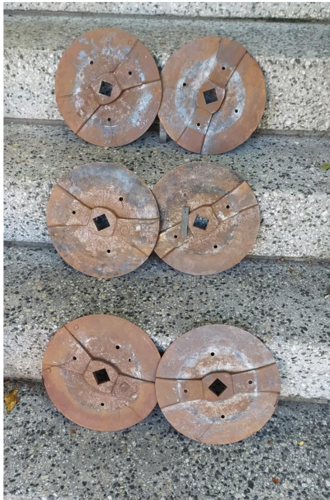
Čela lanových bubnů před a po odstranění koroze
