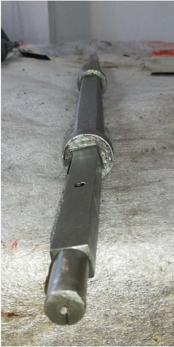
Ohnutá hřídel větrníku bicího stroje čtvrt'ového
