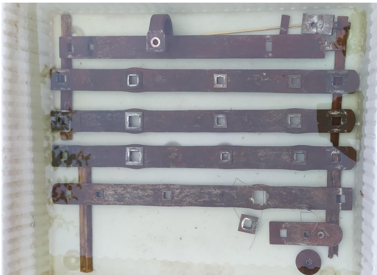
Hlavní kolo bicího stroje čtvrt'ového a ložiskové plotny v odrezovací lázni
