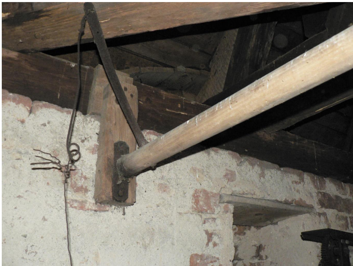
Původní systém převodu tahové síly od bicích strojů k paličkovým strojům
