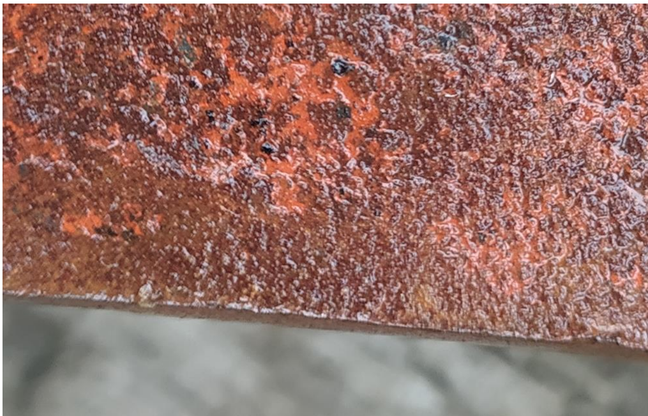
Sonda do vrstev lakování rámu - původní odstín červené olejové barvy
