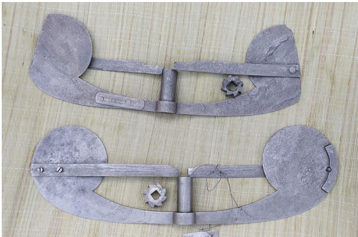
Větrníky bicích strojů po očištění
