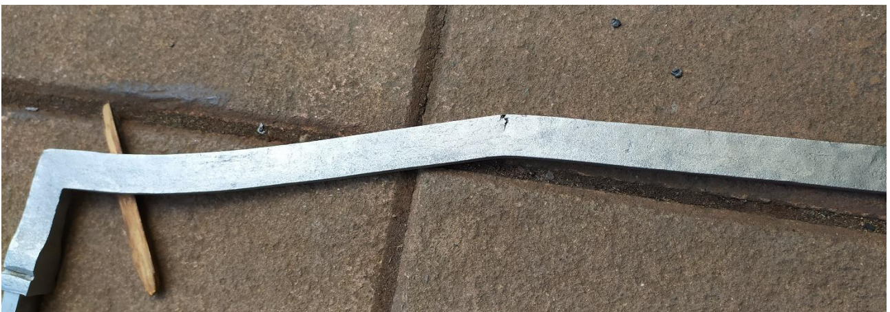
Nalomená páka vypouštění bicího stroje hodinového
