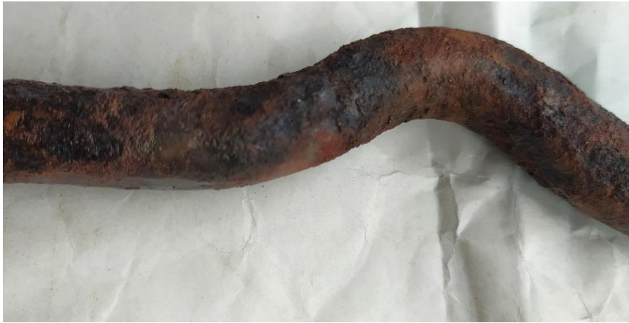
Koroze ucha závažové nádoby. Dole volné kladky závaží po očištění.
