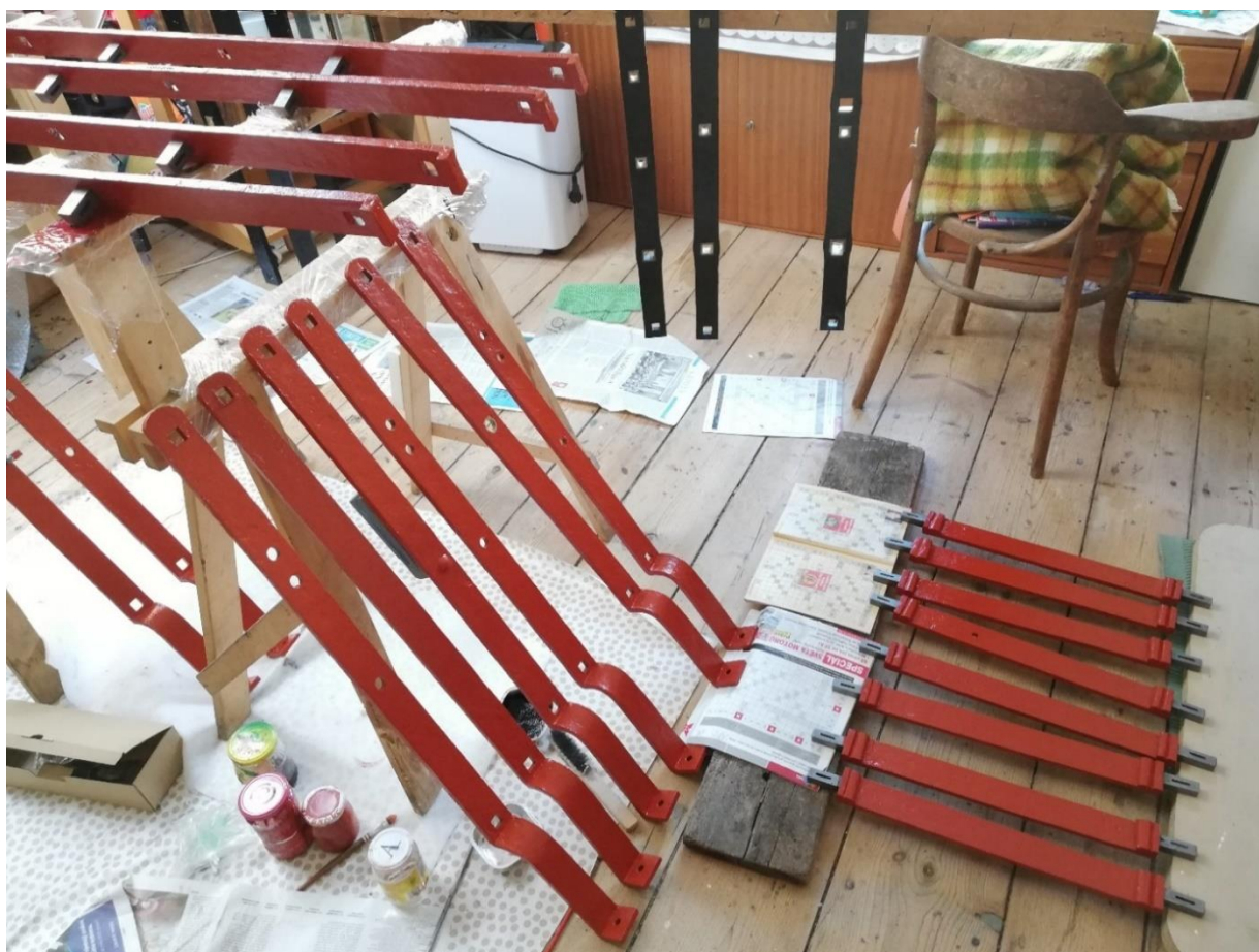
Nátěry dílů rámu hodinového stroje vrchní olejovou barvou
