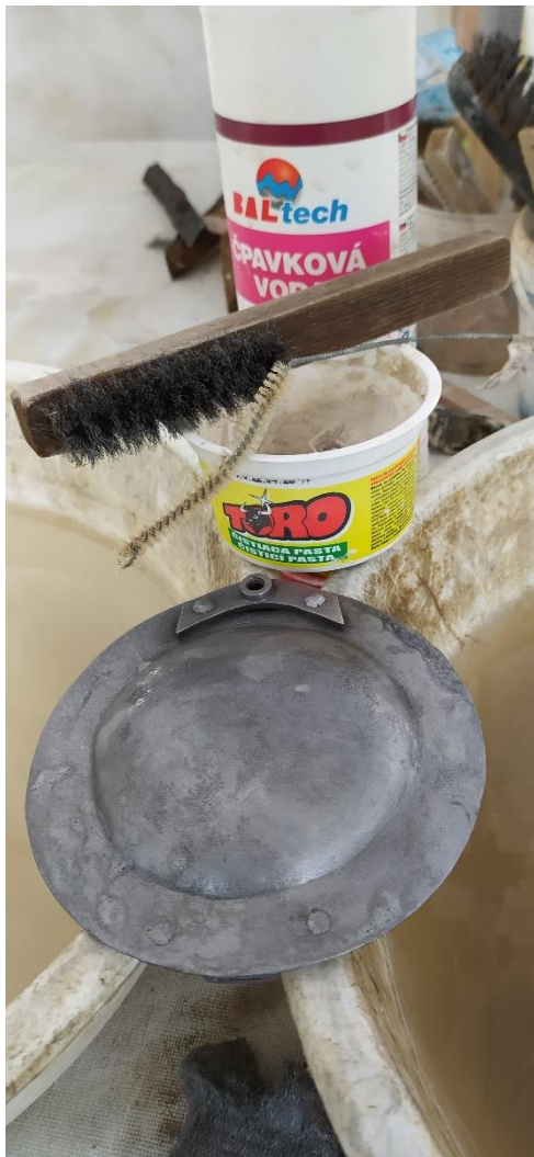
Postup čištění povrchu dílů po odrezovací lázni
