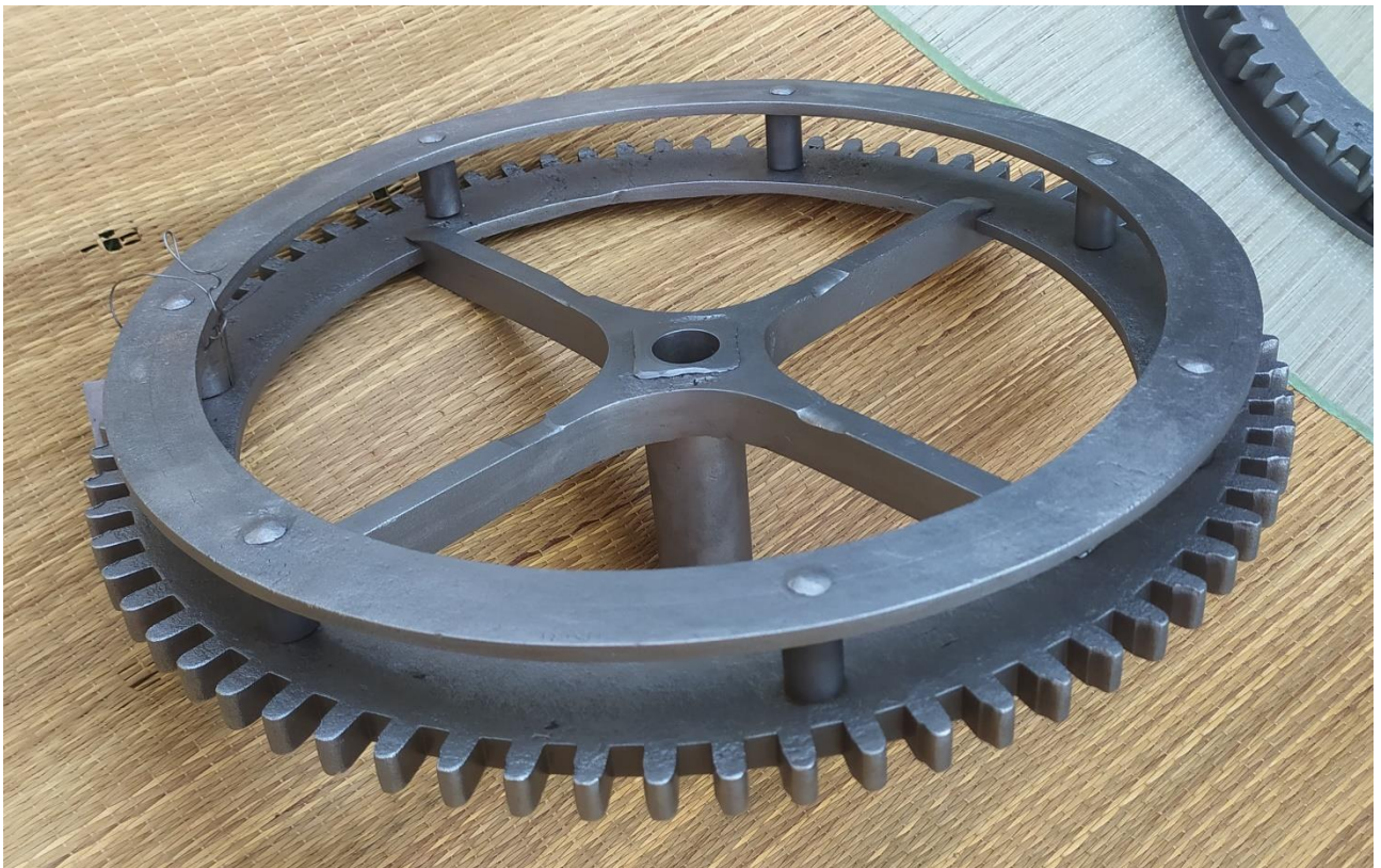
Hlavní kolo bicího stroje hodinového po očištění
