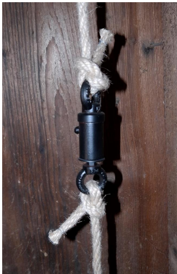
Axiální ložisko u pevného konce lana zabraňující přetáčení volné kladky se závažím vlivem torzního napětí v laně a následného smotávání lana závaží
