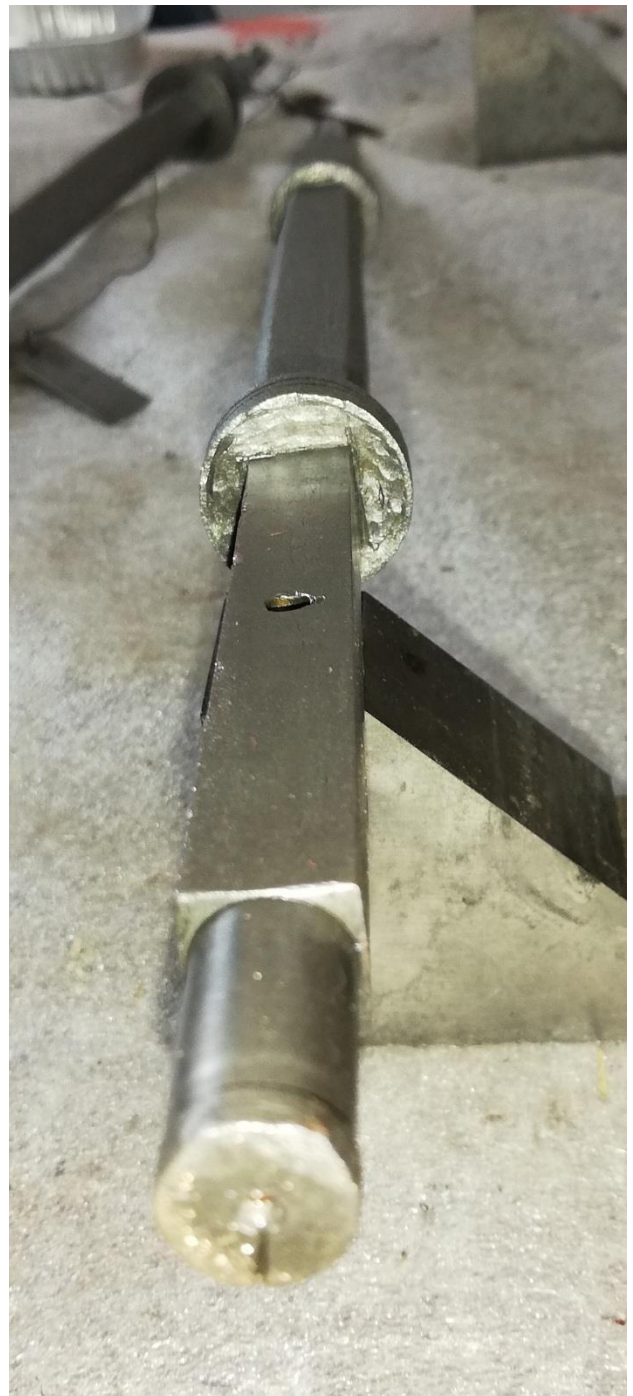
Hřídel větrníku bicího stroje čtvrt'ového po narovnání
